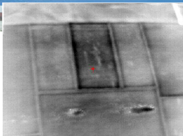
Für das Auge unsichtbare Ablösungen des Sandwich-Laminats werden an einem AC-Copper mittels CAT-NTD identifiziert (links).
