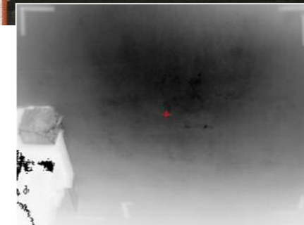
Der Rumpf der aufgepalten Yacht zeigte keine erkennbaren Schäden. Erst die Überprüfung mit CAT-NTD zeigte eine großflächige Delaminierung: ein Transportschaden.
