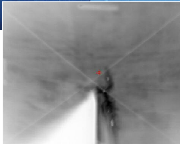
Nur ein kleiner Riss ist am Rumpf nach einer Grundberührung erkennbar. Schwarz-Weiß-Bild: CAT-NTD zeigt, was das bloße Auge nicht sehen kann.
