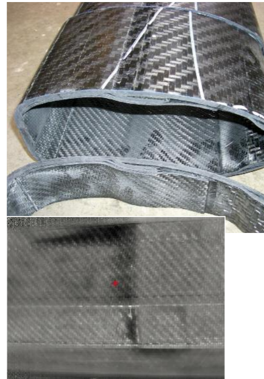
Karbonmast, der nach Prüfung mit CAT-NTD zersägt wurde. Im Meßbild ist die interlaminare Trennung erkennbar.
